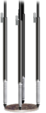
Palpadores de 6 mm para medir el grosor de monedas
