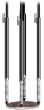
6 mm プローブでのコイン厚さ測定
